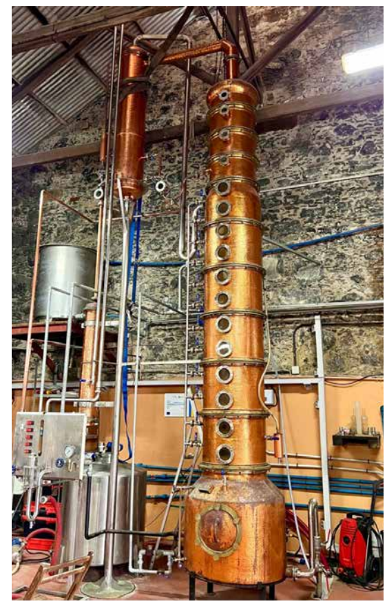
El nuevo alambique destila hasta 1.000 litros de aguardiente de caña en 10 horas.
